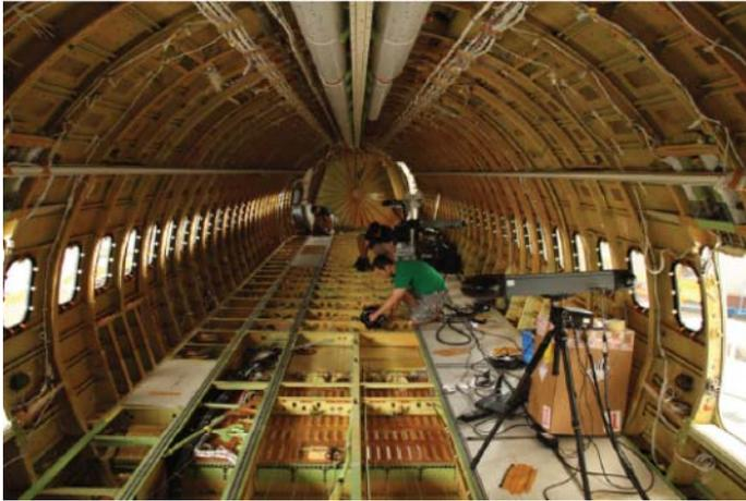
*Figure 11 : utilisation simultanée de plusieurs équipements dans un environnement particulièrement instable grâce à un modèle de positionnement dynamique construit par photogrammétrie*
